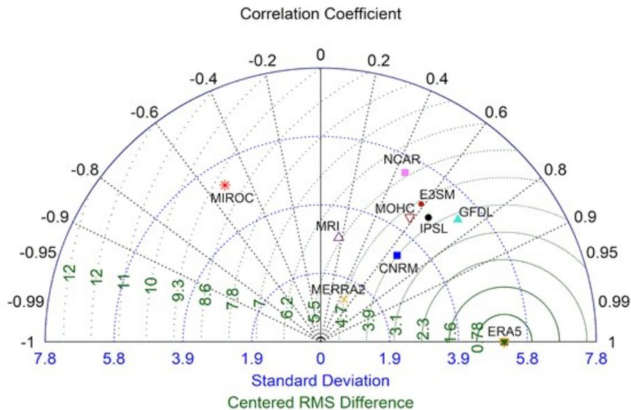
**Figure 3:** Diagramme de Taylor de la nébulosité basse dans le Nord-Ouest du Gabon (juin-septembre 1979-2014) dans les modèles CMIP6 (simulations type AMIP) et les réanalyses MERRA2. Les données ERA5 sont la référence. Pointillés noirs: corrélations. Pointillés bleus: écarts-types. Courbes vertes : erreur quadratique.
